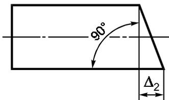
Косину реза ( $\Delta_2$ ) измеряют металлическим угольником по ГОСТ 3749—77, лежащим одной стороной на плоскости расположения слитка, и измерительной линейкой по ГОСТ 427—75. Измерение косины реза проводят на двух торцовых плоскостях.
